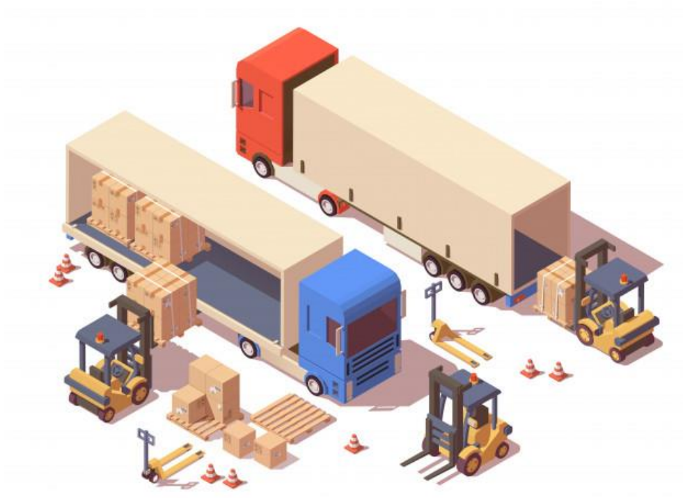
ภาพที่ 24 ภาพแสดงรูปแบบการโหลดสินค้า Back Loading (แดง) และ Side Loading (น้ำเงิน)
