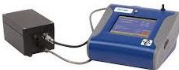
ภาพที่ 31 เครื่อง DustTrak II Model 8530 ยี่ห้อ TSI ที่ใช้วัดค่าฝุ่นละอองในอากาศ (ที่มาภาพ: https://www.tsi.com/dusttrak-ii-aerosol-monitor-8530/ , เข้าถึงเมื่อวันที่ 4 ตุลาคม พ.ศ.2563)
