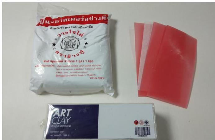
ภาพที่ 115 วัสดุที่ใช้หล่อแบบ ปูนปลาสเตอร์ แผ่นซีฟิ่ง และดินน้ำมัน
