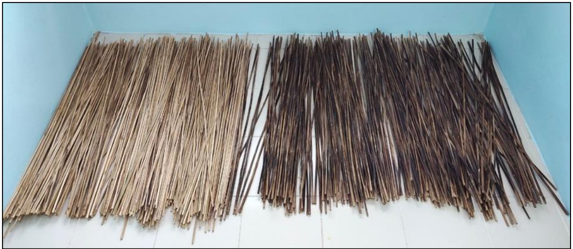
ภาพที่ 34 ไม้ไผ่แช่น้ำยาวจะมีอ่อน ส่วนไม้ไผ่ที่รมควันจะมีสีเข้ม
