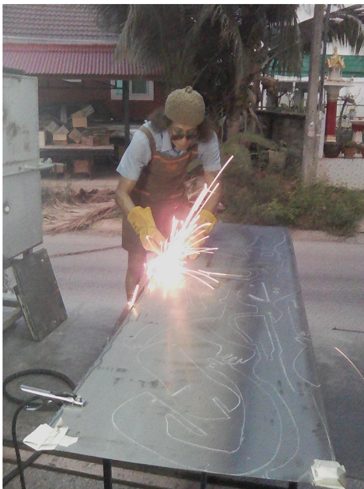
ภาพที่ 73 รูปขยายสเก็ดแสดงถึงการตัดเหล็กแผ่นเพื่อไปประกอบ
