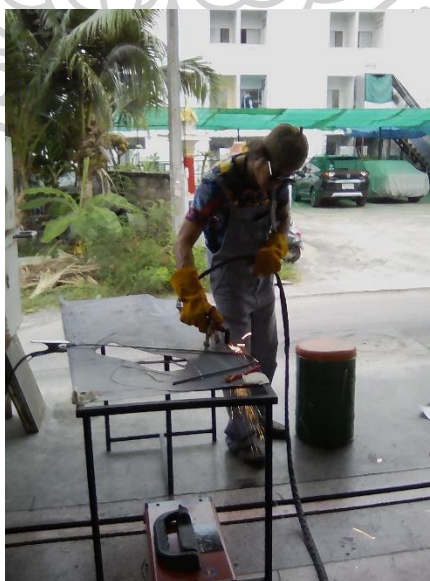
ภาพที่ 74 รูปขยายสเก็ด แสดงถึงการวางแผ่นเหล็กที่สะดวกและปลอดภัยในการตัด
