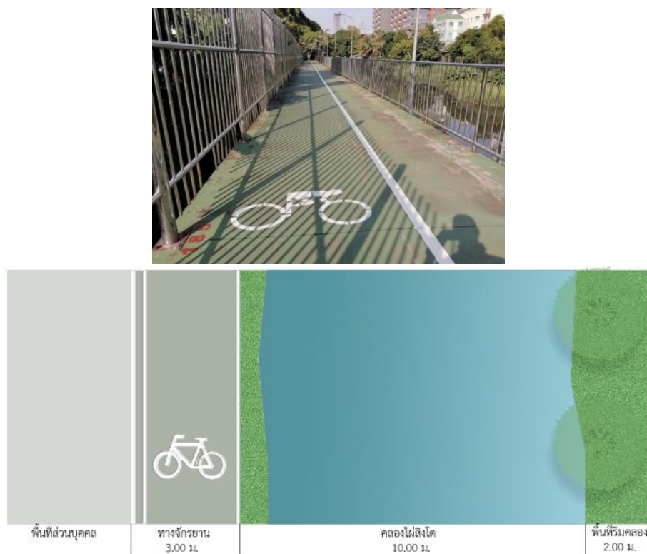
รูปที่ 100 ลักษณะช่องทางจราจรของทางจักรยานบริเวณเส้นทางมุ่งไปสู่สวนเบญจกิติ
