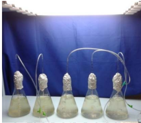
รูปภาคผนวกที่ ข.1 การเพาะเลี้ยงสาหร่าย Chlorella vulgaris ในอาหารสูตร BG-11 ภายใต้สภาวะที่มีการให้อากาศและแสงที่มีความเข้ม 2,000 ลักซ์วันละ 12 ชั่วโมง
