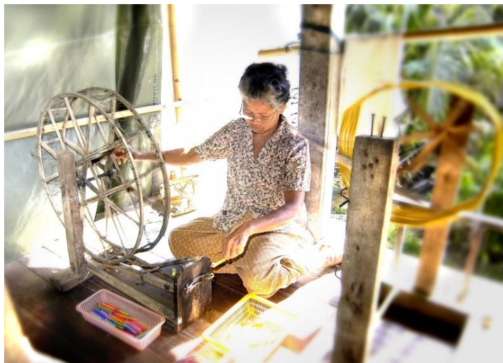
ภาพที่ 91 กรอเส้นไหมใส่หลอดสำหรับฟุงกระสวยเวลาทอ ที่มา: วีรธรรม ตระกูลเงินไทย
