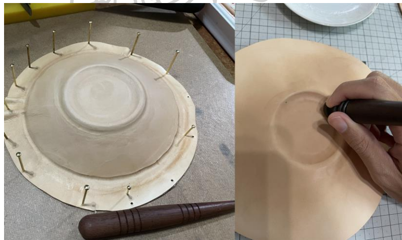
ภาพที่ 32 ภาพการขึ้นโครงสร้างด้วยวิธีการ wet forming ที่มา : ภาพถ่ายโดย นายกชกร โสทะกะพันธ์ โดยใช้เทคนิคการดันละลายค่อยๆกดหนึ่งไปตามรูปทรงของภาชนะตอนยังหมาดๆ เมื่อได้รูปทรงที่ต้องการแล้วจึงตากลมไว้จนแห้ง
