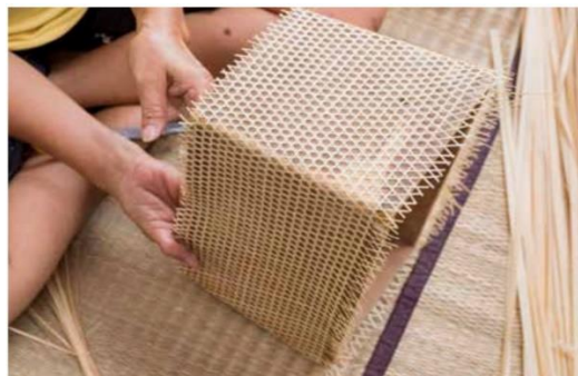
ภาพที่ 13 แสดงขั้นตอนขึ้นโครงบนพิมพ์ขึ้นรูปตระกร้าทรงเหลี่ยม ที่มา : (ศูนย์ส่งเสริมศิลปาชีพระหว่างประเทศ (องค์การมหาชน), 2562: 13)
