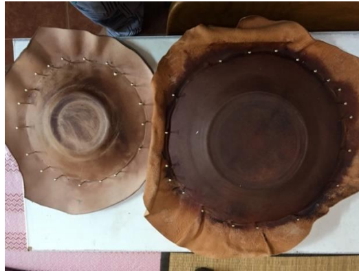
ภาพที่ 31 ภาพหนังวัวอยู่ในระหว่างกระบวนการตัดทรงด้วยน้ำ ที่มา : ภาพถ่ายโดย นายกชกร โสทะกะพันธ์ โดยด้านขวาเป็นหนังวัวและด้านซ้ายเป็นหนังแกะหนังทั้งสองชิ้นเป็นหนังฟอกฝาด จึงสามารถนำมาทดลองด้วยวิธีการตัดด้วยน้ำได้
