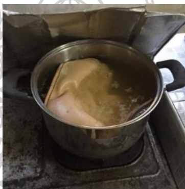
ภาพที่ 29 หนังวัวทดลองการตัดน้ำด้วยน้ำร้อน ทำให้เกิดการหดตัวอย่างรวดเร็ว ผลการทดลองคือหนังแข็งและเสียหาย ที่มา : ภาพถ่ายโดย นายกชกร โสทะกะพันธ์
