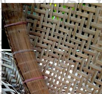
ภาพที่ 4.93 ส่วนประกอบ การยึดปากขอบกระด้ง จากไม้ไผ่ 2 แผ่นประกบ
