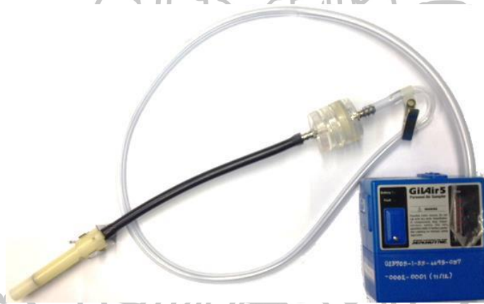
รูปที่ 3.18 การประกอบตัวเก็บตัวอย่างอากาศกรองเข้ากับไซโคลนเก็บตัวอย่าง PM 4
