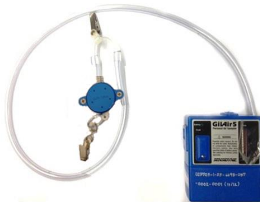
รูปที่ 3.19 การประกอบปั๊มดูดอากาศกับ PEM
