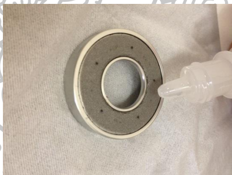
รูปที่ 3.16 การหยดน้ำมันบนอิมแพ็คเตอร์
