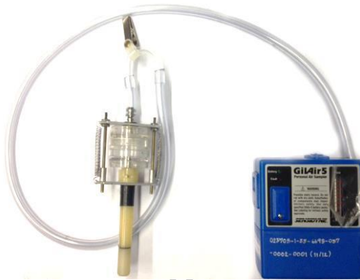
รูปที่ 3.17 การประกอบตัวเก็บตัวอย่างอากาศกรองเข้ากับไซโคลนเก็บตัวอย่าง PM 10
