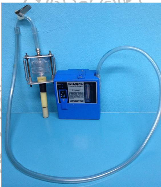
รูปที่ 2.8 การประกอบชุดเก็บตัวอย่างอากาศแบบพกพา
