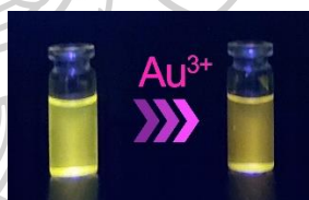
ภาพที่ 57 แสดงการคายแสงฟลูออเรสเซนซ์ที่เปลี่ยนแปลงไปก่อน (ซ้าย) และหลังไตเตรทด้วยไอออนทอง (ขวา) ภายใต้แสงยูวีจากหลอดยูวี (UV lamp)
