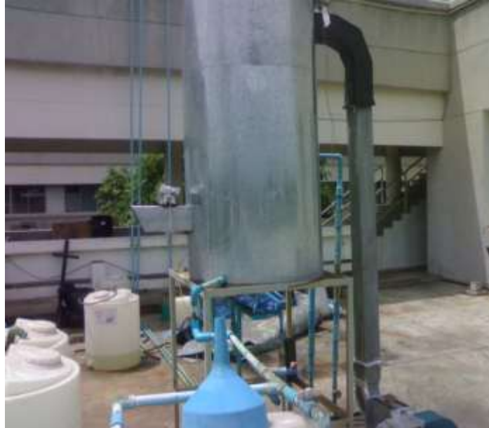
รูปที่ 3.6 เครื่องดูดความชื้นที่ใช้ในการทดลอง
