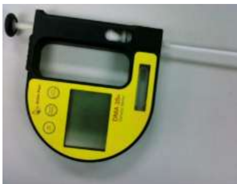
รูปที่ 3.13 เครื่องวัดความหนาแน่นของสารละลาย
