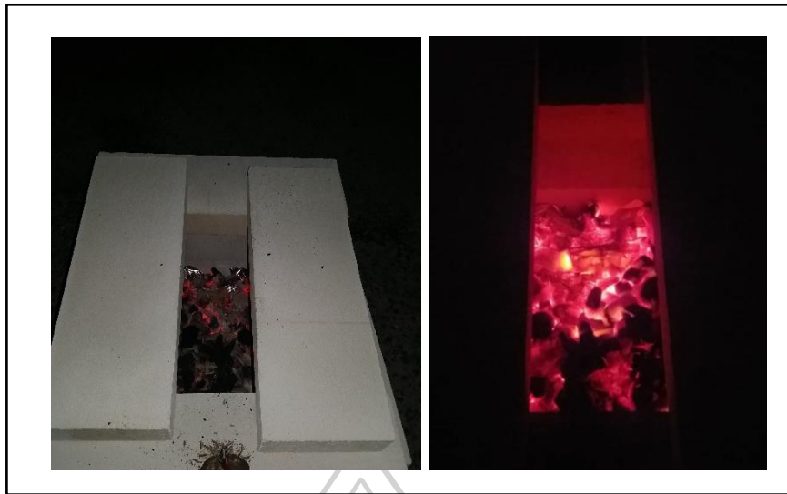
ภาพที่ 18 เเผาชิ้นงานที่อุณหภูมิ 800- 1,250 องศาเซลเซียส 3-5 ชม.
