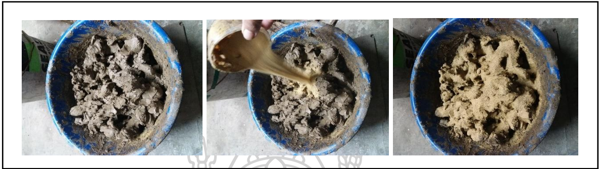
ภาพที่ 14 ผสมดินเหนียวกับทรายก่อนนำมาปั้นขึ้นรูป
