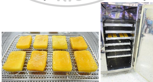
ภาพที่ 10 การเรียงชั้นมะม่วงแช่อิ่มสำหรับการทำแห้งและเครื่องอบแห้งลมร้อนแบบถาด
