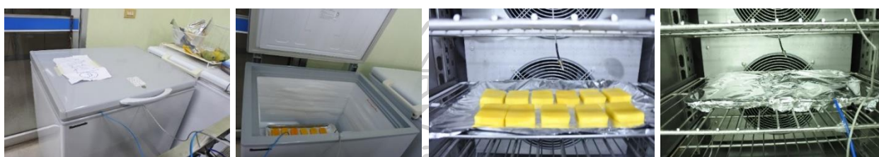
ภาพที่ 7 การแช่ชิ้นมะม่วงในตู้แช่เยือกแข็งแบบช้าและตู้แช่เยือกแข็งแบบเร็ว
