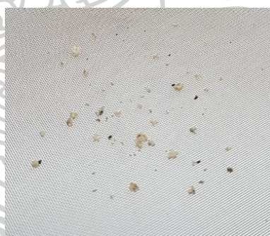
รูปที่ 3.12 ตะกรันที่ไม่ผ่านตะแกรงขนาด 212 ไมโครเมตร (Loose Slag)
