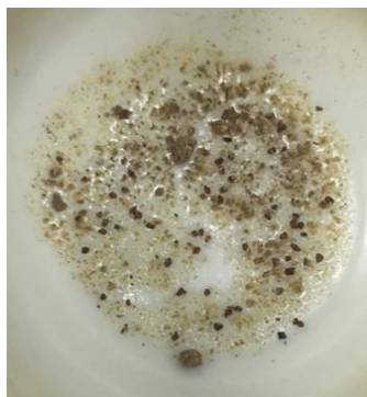
รูปที่ 3.13 ตะกรันแข็งหลอมละลายติดกันง่าย (Hard Slag)
