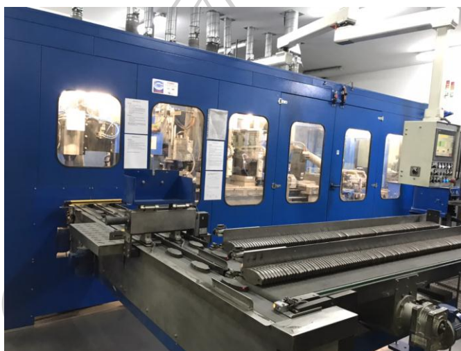
รูปที่ 34 เครื่องฝนตแต่งดิสก์เบรกในกระบวนการฝนตแต่ง
