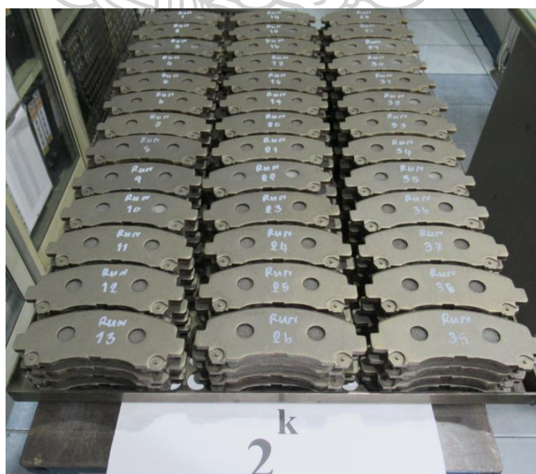
รูปที่ 42 ชิ้นงานจากการทดลอง 2^k Full Factorial Design (Run 1-39)
