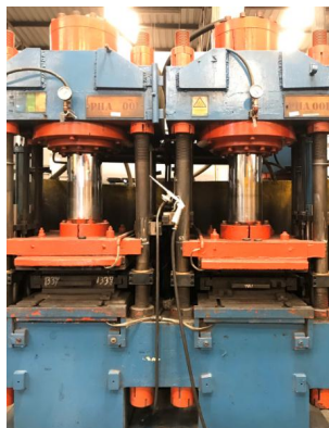
รูปที่ 36 เครื่องอัดขึ้นรูปร้อน ในกระบวนการอัดขึ้นรูปร้อน
