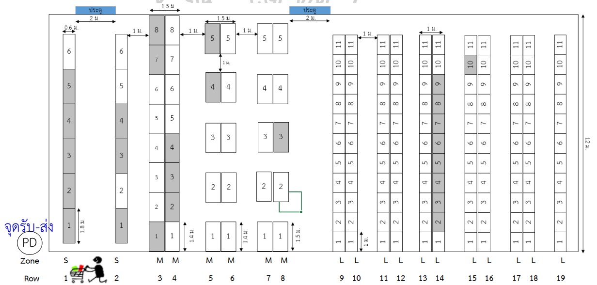
ภาพที่ ช-10 ตำแหน่งการหยิบชิ้นส่วนของเครื่องพิมพ์รุ่น LEC2-33
