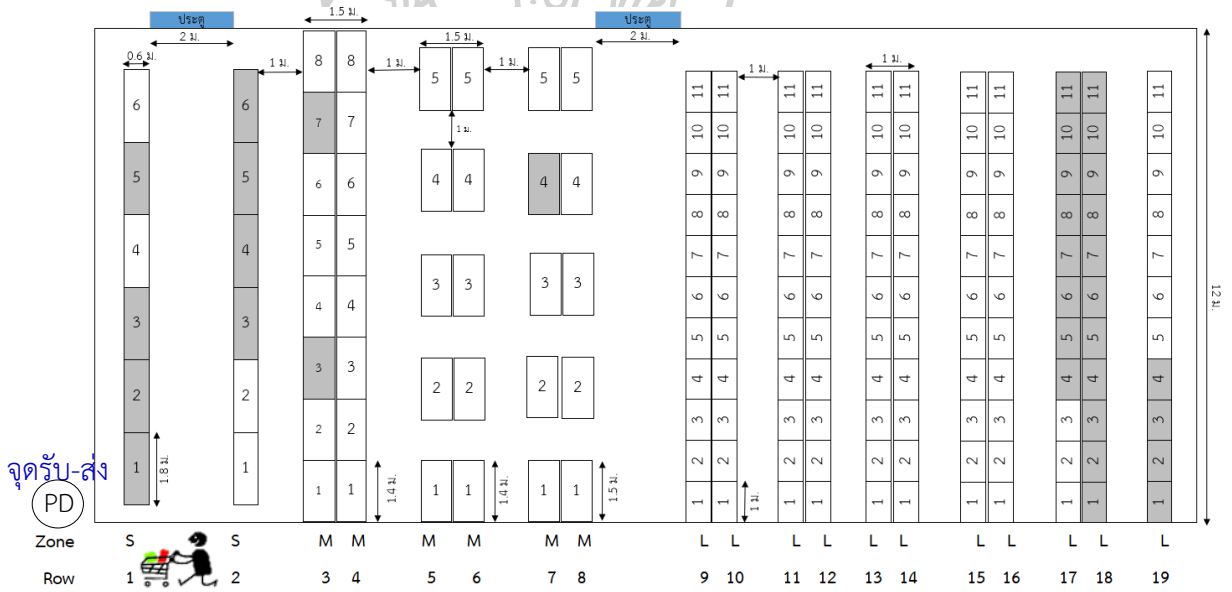
ภาพที่ ช-14 ตำแหน่งการหยิบชิ้นส่วนของเครื่องพิมพ์รุ่น SP-54
