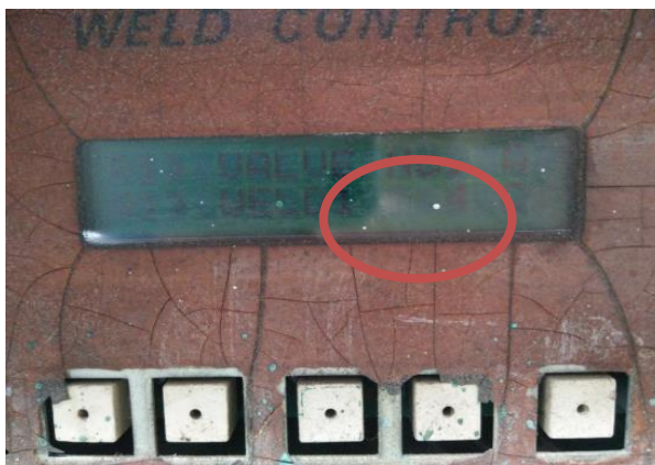
ภาพที่ 36 ระยะเวลาในการเชื่อมที่ตั้งค่าไว้แสดงบนจอมอนิเตอร์เครื่องจักร
