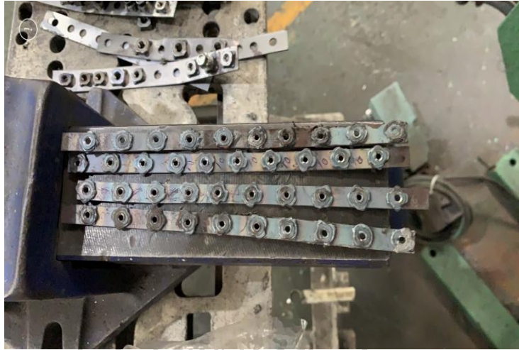
ภาพที่ 47 ตัวอย่างชิ้นงานจากการทดลอง 3^k Full Factorial Design
