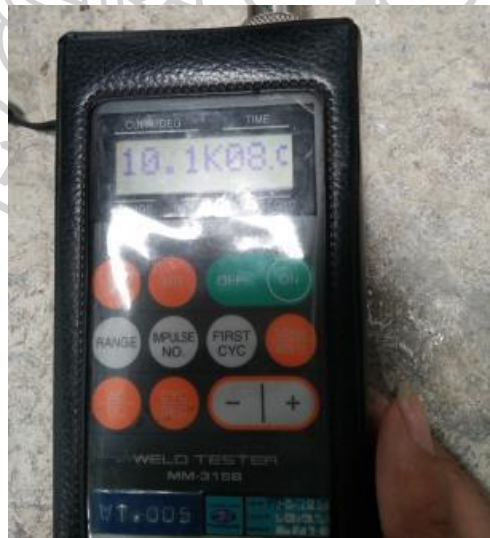
ภาพที่ 35 ตัวอย่างเครื่องวัดค่ากระแสไฟจากเครื่องจักร
