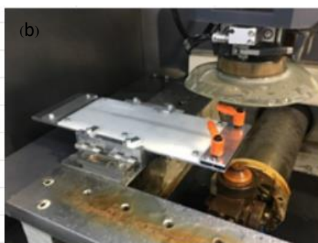
(b) ประกอบฐานตัดงานเข้ากับฐานของเครื่องจักร EDM
