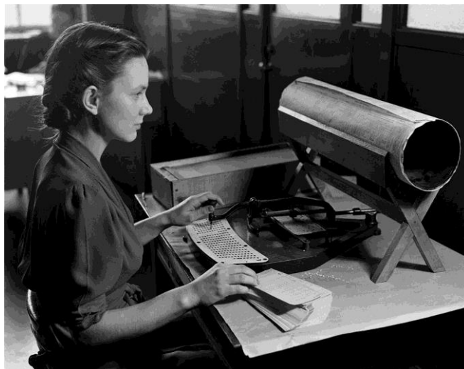
ภาพที่ 36 คอมพิวเตอร์ระบบ Punch cards Interface
