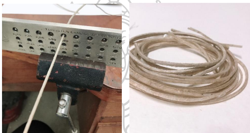
ภาพที่ 99 การใช้เครื่องมือในการทำเครื่องประดับ แป้นดิ่งลวด(โลหะ)มาสร้างรูปทรงใหม่ที่ส่งเสริมให้ความหนา ความแข็ง ความเหนียวของวัสดุ
