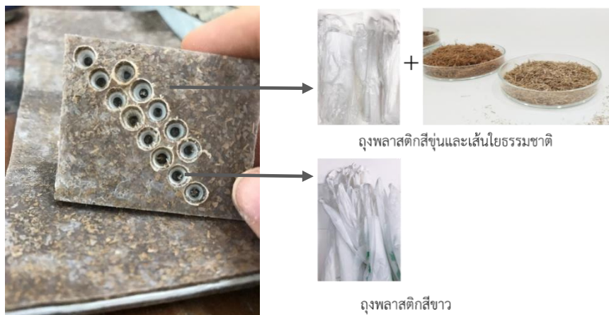
ภาพที่ 104 แสดงการเจาะให้เห็นชั้นของวัสดุ
