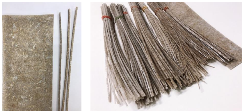
ภาพที่ 98 การตัดแบ่งวัสดุที่รีดเป็นแผ่นหนาให้กลายเป็นเส้น
