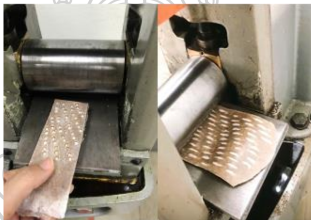
ภาพที่ 105 การนำวัสดุที่เจาะแล้วไปเข้าเครื่องรีด เพื่อให้วัสดุยืด ขยาย ด้วยแรงบีบ กด จนเกิดเป็น ลวดลาย
