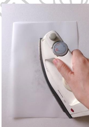
5. ให้ความร้อนกับวัสดุโดยใช้เตารีด ที่อุณหภูมิ 100 -130 องศาเซลเซียส นาน 1 นาที เพื่อให้วัสดุประสานกัน
