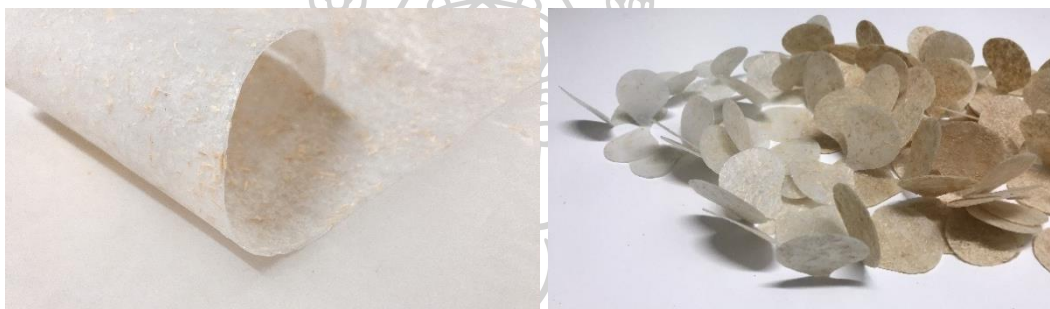
ภาพที่ 114 วัสดุชนิดแผ่นจากเส้นใยธรรมชาติและแผ่นพลาสติกจำนวน 5 ชั้น
