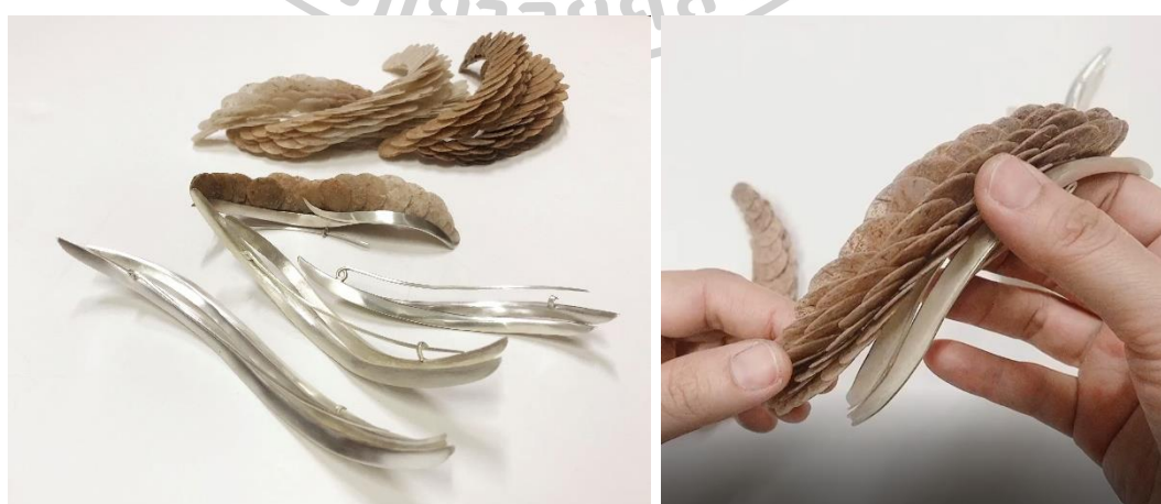
ภาพที่ 121 การประกอบตัวเรือนเครื่องประดับที่ทำจากโลหะเงิน
