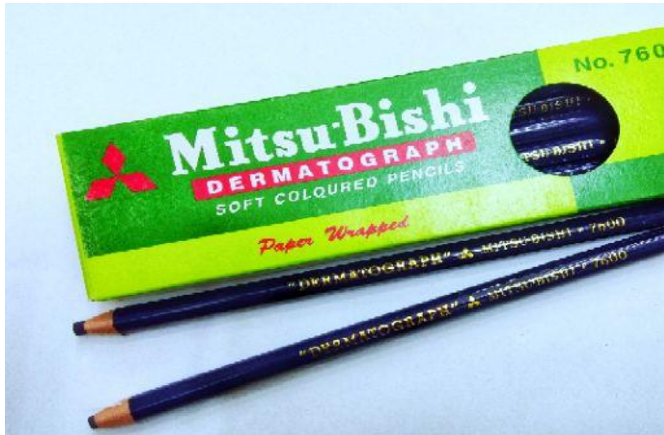
ภาพที่ 15 แสดงอุปกรณ์ที่ใช้สำหรับการเขียนบนแผ่นแม่พิมพ์
