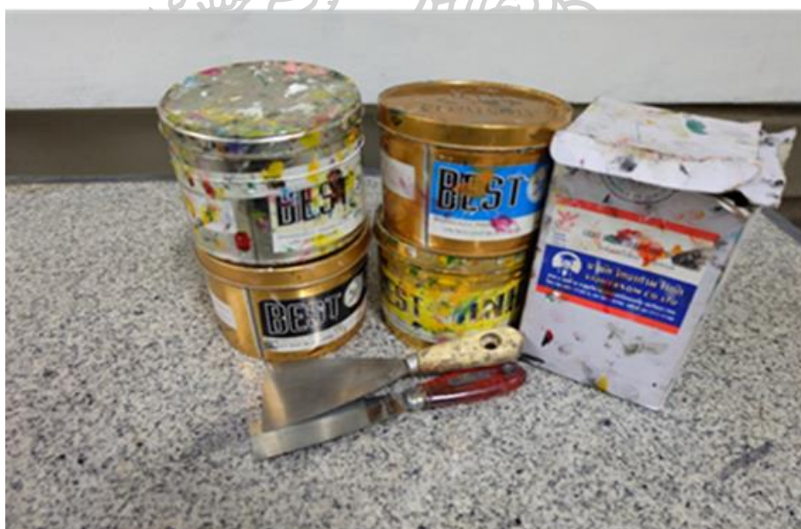
ภาพที่ 19 แสดงอุปกรณ์สำหรับขั้นตอนการพิมพ์ เช่น หมึกพิมพ์ออฟเซต เกรียง ผงไลท์ แมกนีเซียมคาร์บอเนต
