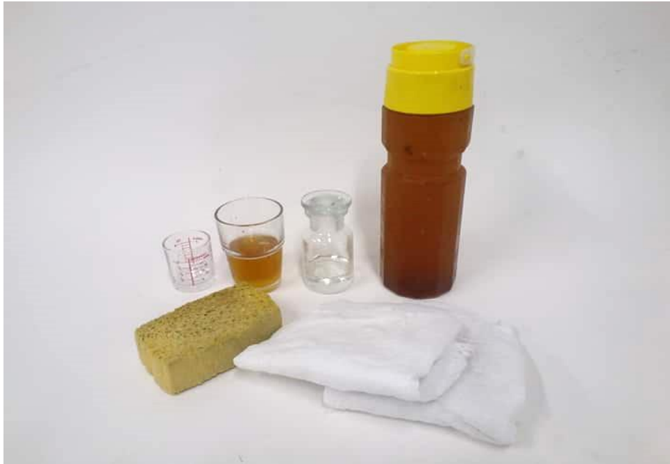
ภาพที่ 36 ภาพแสดงวัสดุอุปกรณ์ที่ใช้ในขั้นตอนการกักรีดและการเคลือบกาวแม่พิมพ์
