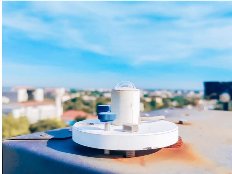
รูปที่ 36 เครื่องความเข้มแสงสว่างที่ติดตั้งที่คณะวิทยาศาสตร์ มหาวิทยาลัยศิลปากร จังหวัดนครปฐม
