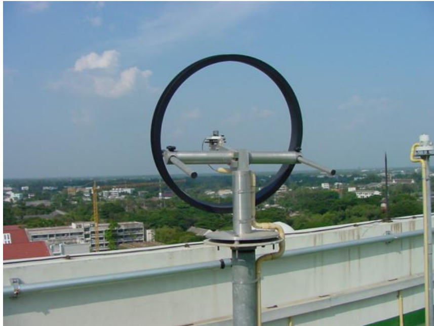
รูปที่ 17 แสดงเครื่องวัด diffuse illuminance บนพื้นราบ
