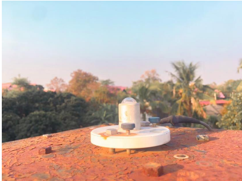
รูปที่ 34 เครื่องความเข้มแสงสว่างที่ติดตั้งที่ศูนย์อุตสาหกรรมวิทยภาคเหนือ จังหวัดเชียงใหม่
