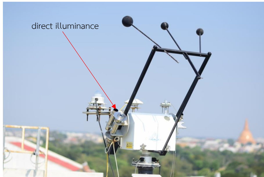
รูปที่ 19 แสดงเครื่องวัด direct illuminance บนพื้นราบ
