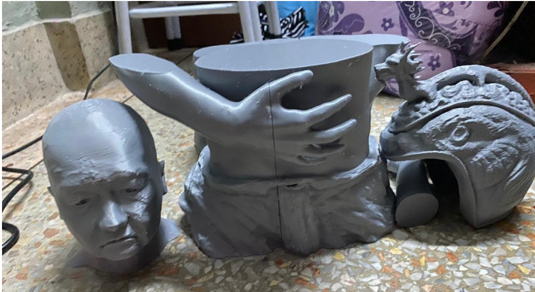
ภาพที่ 48 ภาพชิ้นงานที่แกะ Subport เรียบร้อยแล้ว
