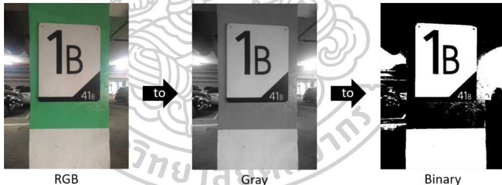
รูปที่ 2.11 ผลลัพธ์ของการแปลงภาพ RGB เป็น Binary
