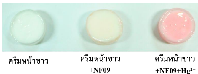
ภาพที่ 124 การทดสอบไอออนปรอทในตัวอย่างครีมหน้าขาว (skin lightening cream)
