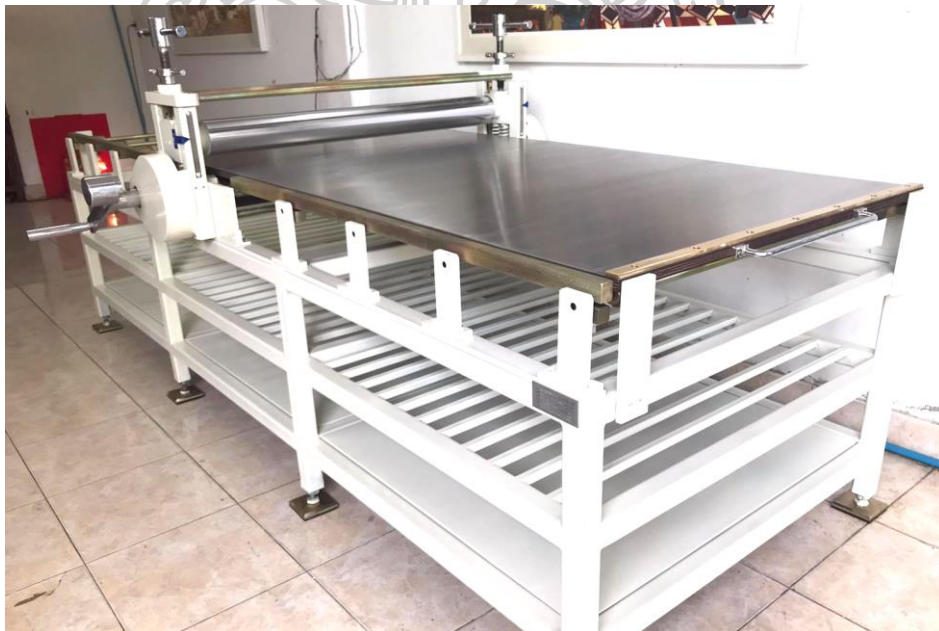
ภาพที่ 25 ภาพแท่นพิมพ์ภาพพิมพ์แกะไม้
