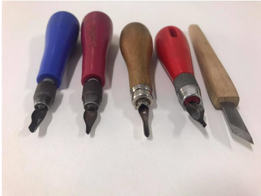
ภาพที่ 22 ภาพอุปกรณ์ในการแกะสร้างร่องรอยแม่พิมพ์
