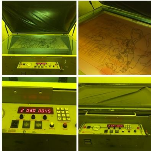
ภาพที่ 37 ภาพแสดงการฉายแสงลงบล็อกสกรีน เพื่อให้เป็นแม่พิมพ์
