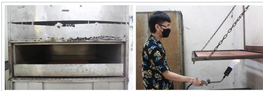
ภาพที่ 19 ภาพแสดงขั้นตอนการโรยผงแอสฟัลต์และนำแม่พิมพ์ไปย่างด้วยความร้อน
