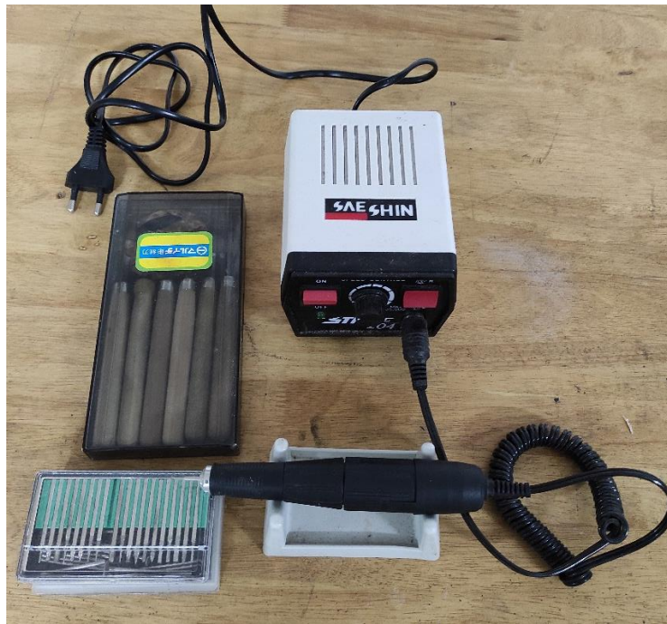
ภาพที่ 34 ภาพถ่ายเครื่องมืออุปกรณ์ในการแกะสร้างร่องรอยบนแม่พิมพ์
