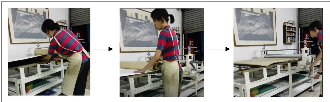
ภาพที่ 31 ภาพถ่ายแสดงขั้นตอนการนำกระดาษและแม่พิมพ์เข้าไปยังแท่นพิมพ์
