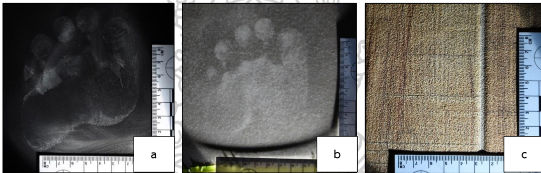
ภาพที่ 4. 6 รอยเท้าแฝงที่ปิดด้วยวิธีผงฝุ่นซิลิกาผสมยางสน 5% และสีผสมอาหารสีเหลือง บนกระเบื้องทั้ง 3 แบบ (a-กระเบื้องพื้นเรียบสีดำ, b-กระเบื้องพื้นเรียบสีขาว, c-กระเบื้องพื้นหยาบ)
