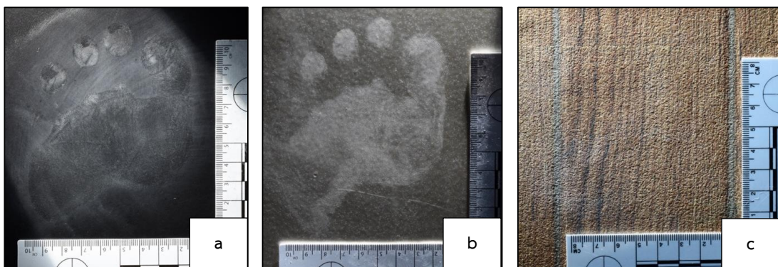
ภาพที่ 4. 20 รอยเท้าแฝงที่ปิดด้วยวิธีผงฝุ่นซิลิกาผสมยางสน 25% และสีผสมอาหารสีม่วง บน กระเบื้องทั้ง 3 แบบ (a-กระเบื้องพื้นเรียบสีดำ, b-กระเบื้องพื้นเรียบสีขาว, c-กระเบื้องพื้นหยาบ)
