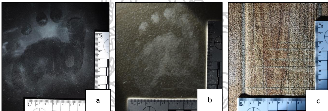
ภาพที่ 4. 12 รอยเท้าแฝงที่ปิดด้วยวิธีฝังฝุ่นซิลิกาผสมยางสน 5% และสีผสมอาหารสีฟ้า บนกระเบื้องทั้ง 3 แบบ (a-กระเบื้องพื้นเรียบสีดำ, b-กระเบื้องพื้นเรียบสีขาว, c-กระเบื้องพื้นหยาบ)
