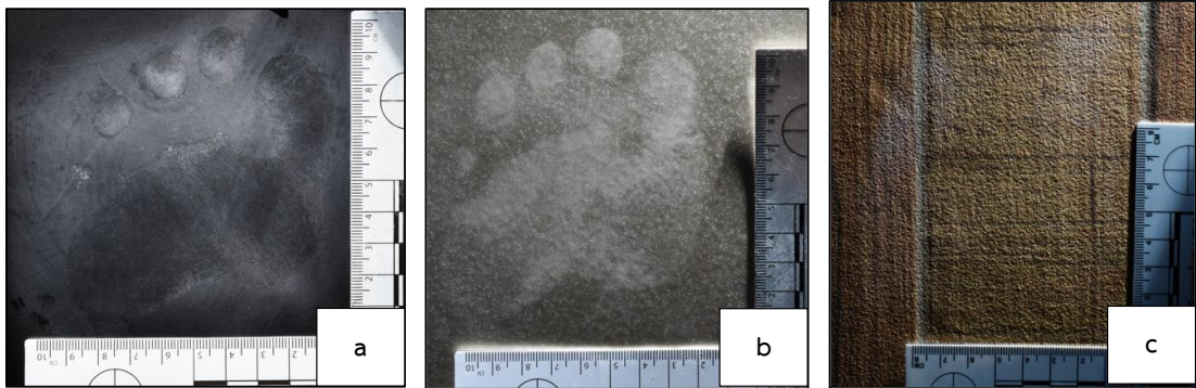
ภาพที่ 4. 17 รอยเท้าแฝงที่ปิดด้วยวิธีฝังฝุ่นซิลิกาผสมยางสน 25% และลิพิดผสมอาหารสีชมพู บน กระเบื้องทั้ง 3 แบบ (a-กระเบื้องพื้นเรียบสีดำ, b-กระเบื้องพื้นเรียบสีขาว, c-กระเบื้องพื้นหยาบ)
