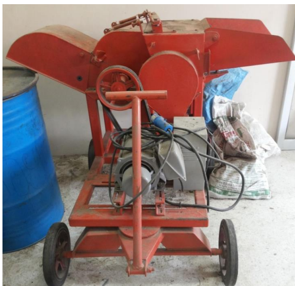
ภาพที่ 36 เครื่องสับหยาบ Gimatic รุ่น MA110
