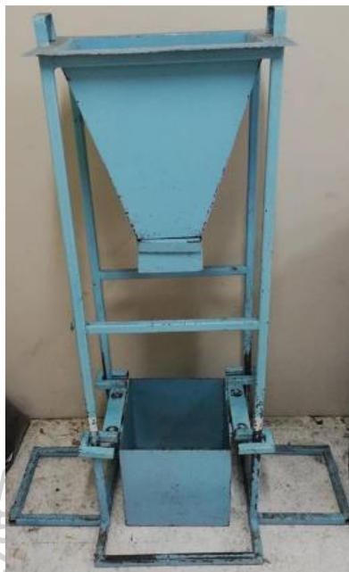
ภาพที่ 33 เครื่องทดสอบหาค่าความหนาแน่นบัลค์
