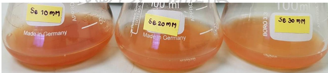
รูปที่ 12 สารละลายอนุภาคนาโนซีลีเนียมจากสภาวะการใส่ sodium selenite ที่ความเข้มข้น 10, 20 และ 30 mM ที่เวลาบ่ม 72 ชั่วโมง
