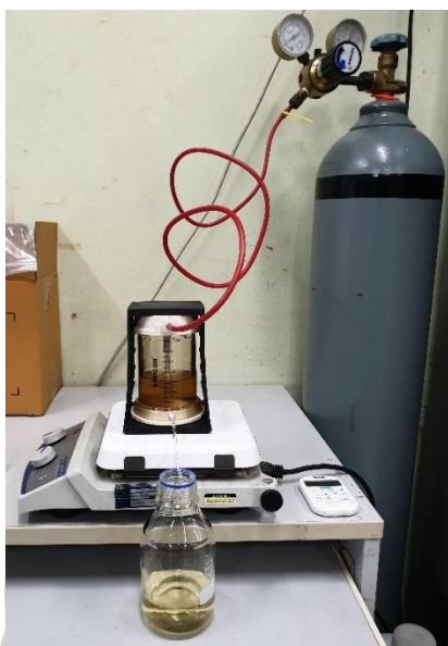
ภาพที่ 16 การกรองสารละลายเพกตินด้วยวิธีการกรองผ่านเมมเบรน
