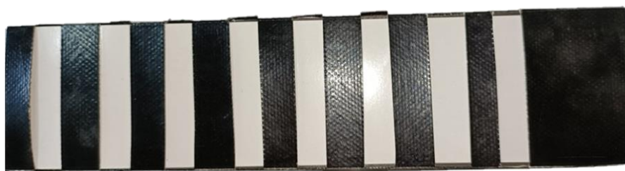
ภาพที่ 44 ซองใส่แผ่นสีมาตรฐานสำหรับนำไปวัดสเปกตรัม
