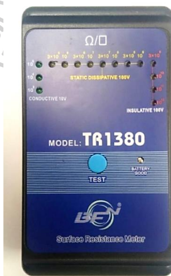
ภาพที่ 3.9 เครื่องทดสอบความต้านทานไฟฟ้าที่พื้นผิว (Surface resistance meter)
