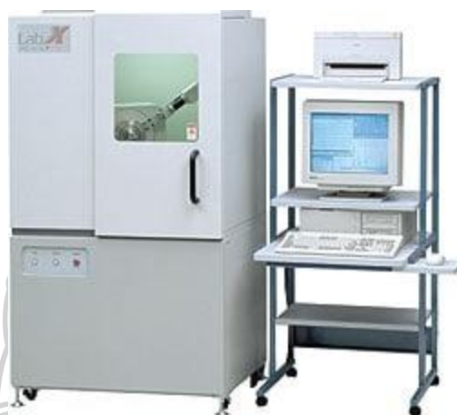
ภาพที่ 3.3 เครื่อง X-ray Diffractometer (XRD)
