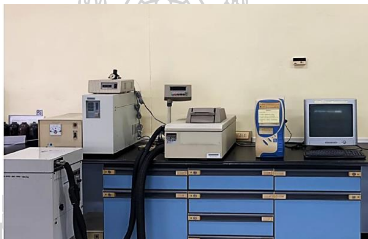
ภาพที่ 3.12 เครื่อง Differential scanning calorimeter (DSC)
