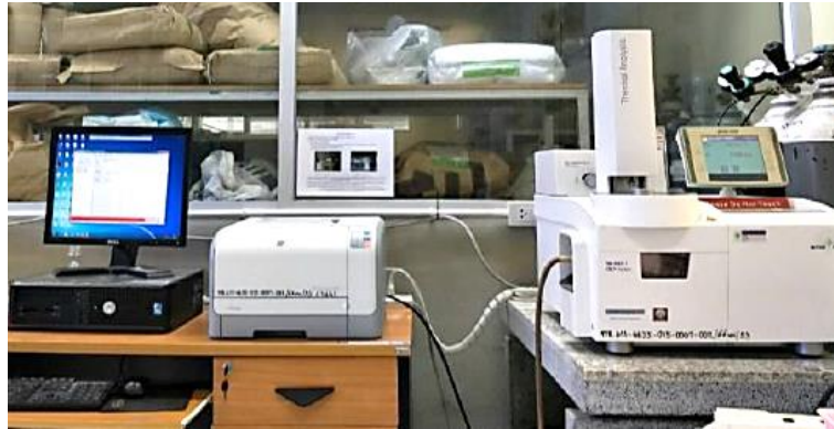
ภาพที่ 3.5 เครื่อง Thermogravimetric analyzer (TGA)
