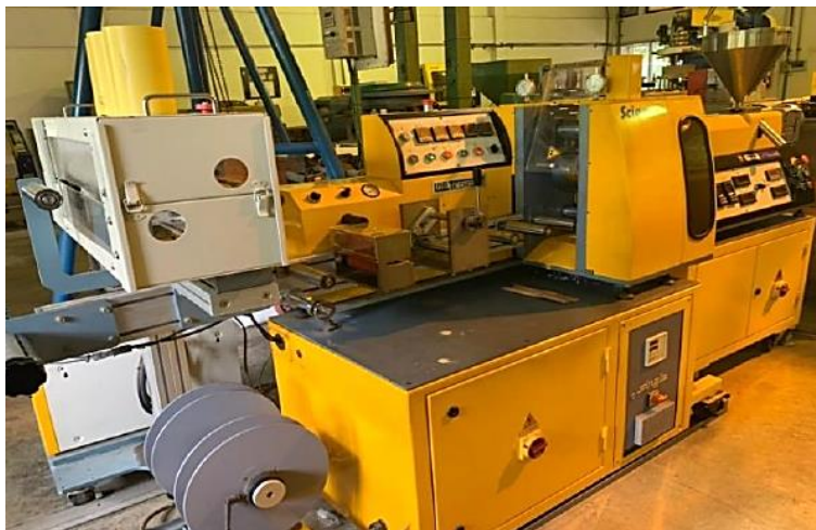
ภาพที่ 3.8 เครื่องอัดรีดแผ่นฟิล์ม (Cast film extruder)
