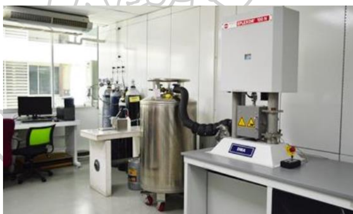
ภาพที่ 3.10 เครื่อง Dynamic mechanical thermal analyzer (DMTA)
