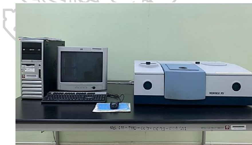
ภาพที่ 3.1 เครื่อง Fourier transform infrared spectroscope (FTIR)
