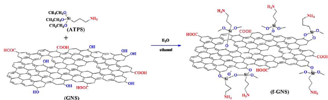
ภาพที่ 2.15 การทำปฏิกิริยาระหว่าง Graphene nanosheet (GNS) กับสารเชื่อมประสาน 3-aminopropyltriethoxysilane [14]
