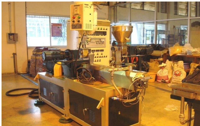
ภาพที่ 3.7 เครื่องอัดรีดแบบสกรูคู่ (Twin-screw extruder)
