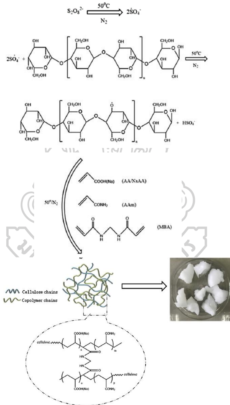
รูปที่ 2.18 แสดงลำดับการเกิดปฏิกิริยาของการสังเคราะห์หัวดูดซับชีวภาพ (MCC-g-(AA-co-AM)) [2]
