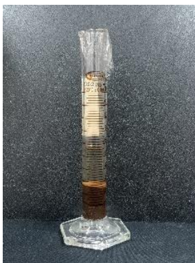
รูปที่ 4.13 การทดสอบการบวมตัวของเรซินแลกเปลี่ยนไอออนบวก จากเซลลูโลสในผักตบชวาที่สังเคราะห์ได้
