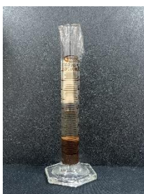
รูปที่ 3.5 การทดสอบการบวมตัว (swelling) ของเรซินแต่ละชนิด
