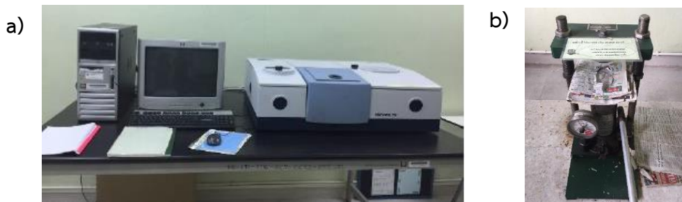
รูปที่ 3.1 a) เครื่อง fourier transform infrared spectrometer รุ่น VERTEX70 ยี่ห้อ Bruker และ b) เครื่องวัดความดันระบบไฮดรอลิก
