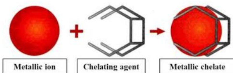
รูปที่ 2.5 หลักการทำงานทั่วไปของกระบวนการ Chelation [23]
