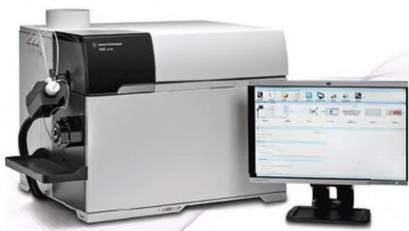
รูปที่ 3.8 เครื่อง Inductively coupled plasma mass spectrometry (ICP-MS) รุ่น 7900 จากบริษัท Agilent ประเทศสหรัฐอเมริกา (7900 ICP-MS, Agilent, USA)
