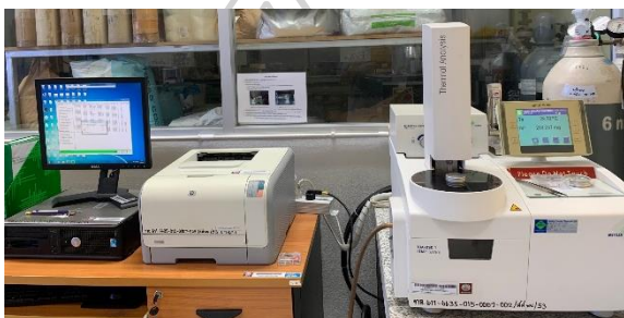
รูปที่ 3.4 เครื่อง Thermogravimetric analyzer รุ่น TGA/DSC1 จากบริษัท Mettler Toledo ประเทศสหรัฐอเมริกา (TGA/DSC1, Mettler Toledo, USA)
