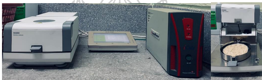
รูปที่ 3.7 เครื่อง Halogen moisture analyzer รุ่น HX204
