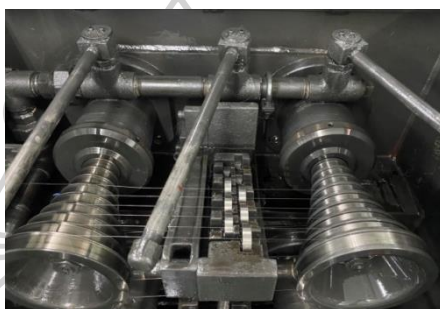
ภาพที่ 3-10 ลักษณะการปรับสายท่อจ่ายน้ำมัน
