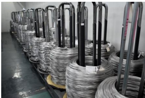
ภาพที่ 3-1 วัตถุดิบที่ใช้ในการรีดลวด
