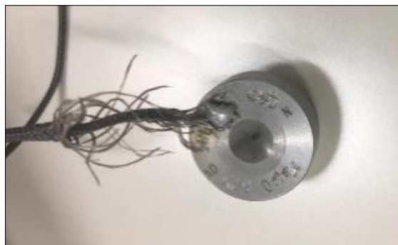
ภาพที่ 4-6 ลักษณะการติด Thermocouple Fiber ที่บริเวณ Dies
