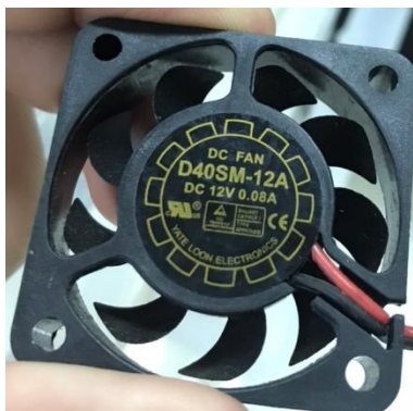
รูปที่ 3.12 พัดลมสำหรับเป่าหมอกเข้าอุโมงค์ลม
