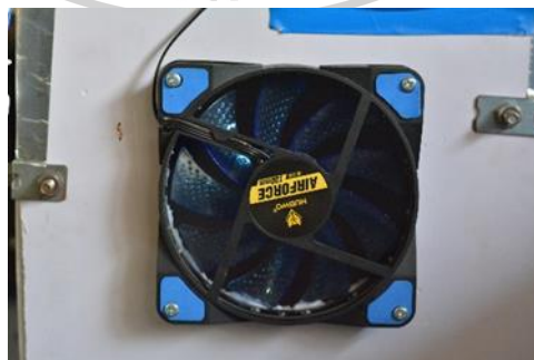
รูปที่ 3.17 พัดลมแกนลูกปืนความเร็วรอบ1,200 RPM
