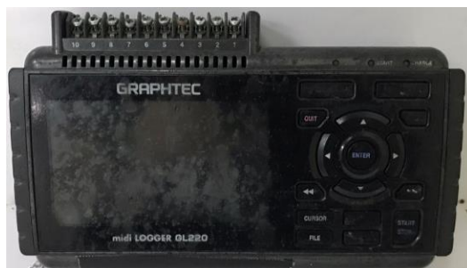
รูปที่ 3.21 เครื่องบันทึกอุณหภูมิ Graphtec midi logger GL220
