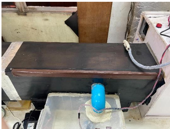
รูปที่ 3.7 ห้องควบคุมความชื้น
