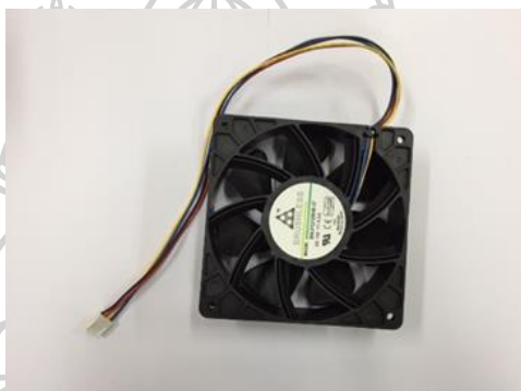
รูปที่ 3.4 พัดลมแกนลูกปืนความเร็วรอบ 7,500 RPM
