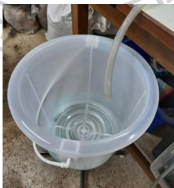
รูปที่ 3.26 ถังพักน้ำจากการซึมผ่านของวัสดุ
