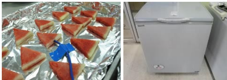
ภาพที่ 23 การแช่เยือกแข็งที่อุณหภูมิ - 18 °C ด้วยเครื่องแช่แข็ง (conventional freezer)
