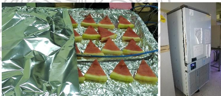
ภาพที่ 24 การแช่เยือกแข็งที่อุณหภูมิ - 40 °C แทนการแช่แข็งแบบเร็ว ด้วยเครื่องแช่เยือกแข็งแบบเป่าลมเย็น (Air blast freezer)
