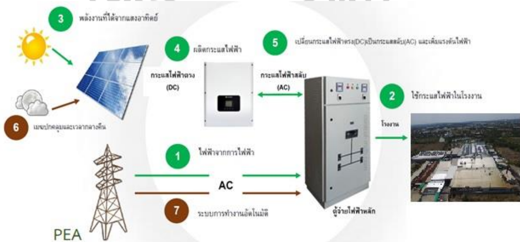
รูปที่ 67 การเชื่อมต่อระบบไฟฟ้าเซลล์แสงอาทิตย์เข้ากับโรงงาน แบบ On-Grid
