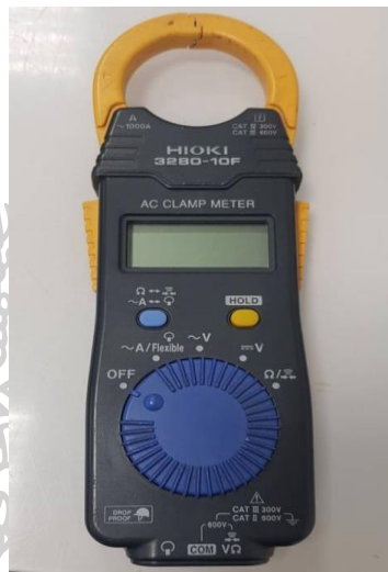
รูปที่ 32 เครื่องวัดแรงดันไฟฟ้า และกระแสไฟฟ้า
