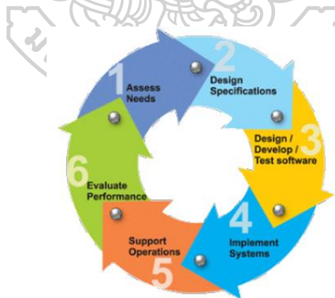
ภาพที่ 2 วงจรพัฒนาระบบ SDLC (โอภาส เอี่ยมสิริวงศ์, 2560)
