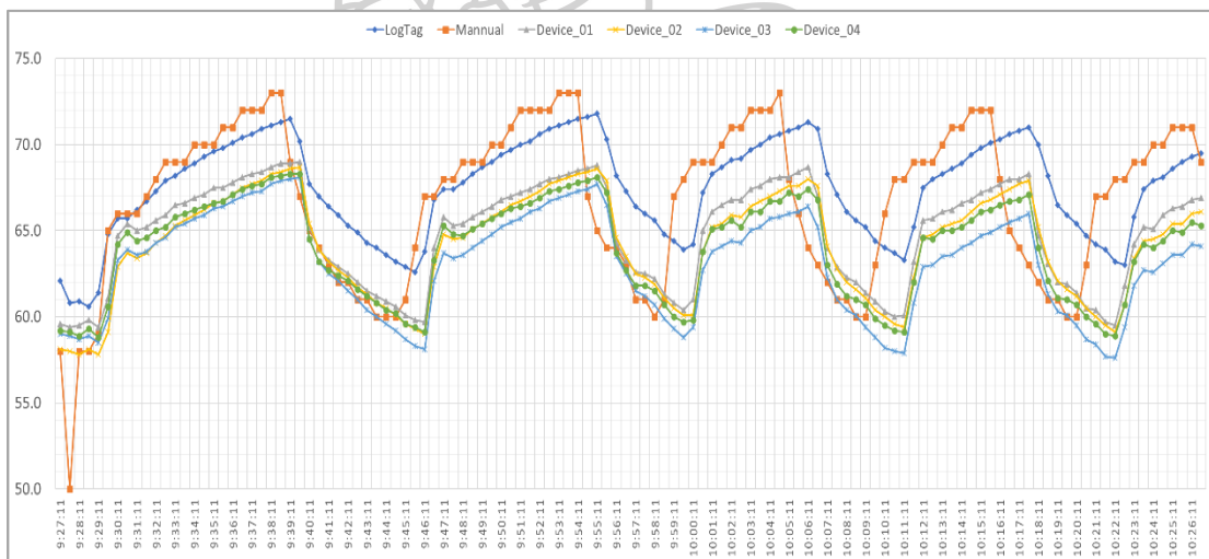
รูปที่ 51 กราฟความชื้นสัมพัทธ์เปรียบเทียบระหว่าง LogTag® อุปกรณ์ IoT และ เครื่องวัดดิจิทัล ทุก 30 วินาที เป็นเวลา 1 ชั่วโมง
