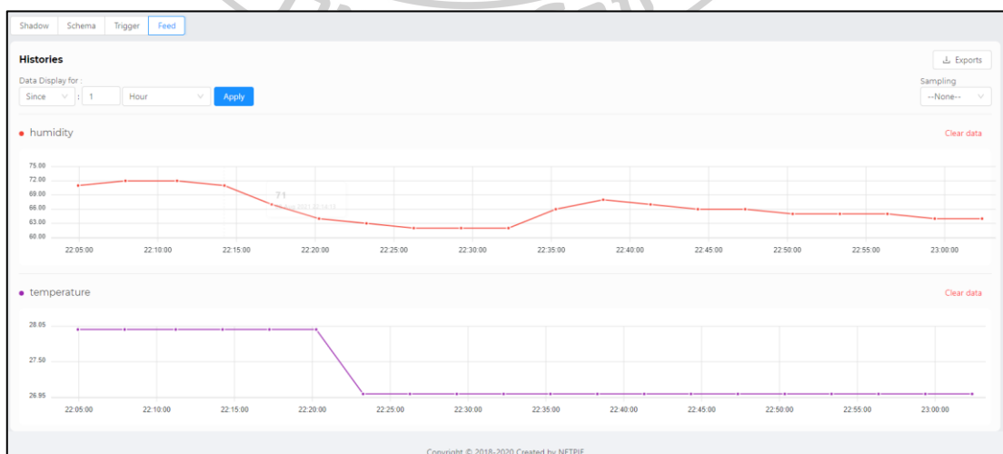
รูปที่ 43 หน้าเว็บแอปพลิเคชันแสดงผลข้อมูลอุณหภูมิและความชื้นจาก NETPIE2020
