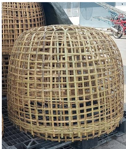
ภาพที่ 149 ตัวอย่างไม้แบบชั่วคราวที่สานจากไม้ไผ่
