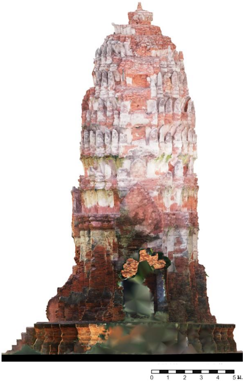
ภาพที่ 24 รูปด้านทิศเหนือ เจดีย์ประธาน วัดลิงกา จากการรังวัดด้วยภาพ (Photogrammetry)
