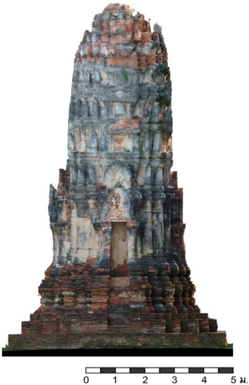
ภาพที่ 10 รูปด้านทิศตะวันตก เจดีย์ประธาน วัดส้ม จากการรังวัดด้วยภาพ (Photogrammetry)
