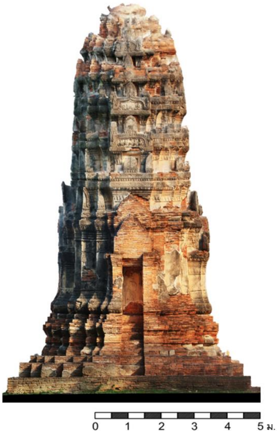
ภาพที่ 9 รูปด้านทิศใต้ เจดีย์ประธาน วัดส้ม จากการจัดสร้างด้วยภาพ (Photogrammetry)
