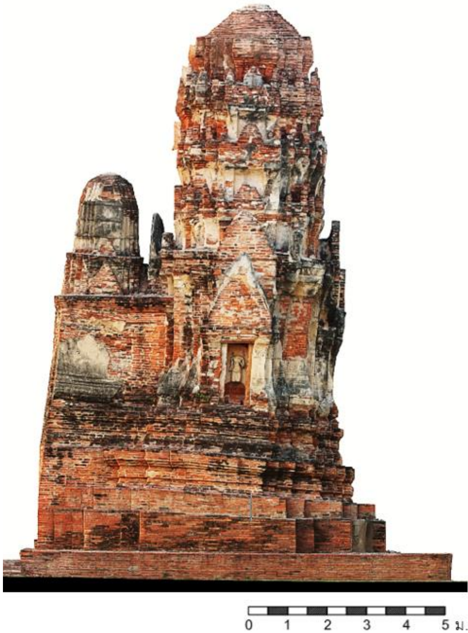
ภาพที่ 47 รูปด้านทิศเหนือ เจดีย์ประธาน วัดนก จากการรังวัดด้วยภาพ (Photogrammetry)
