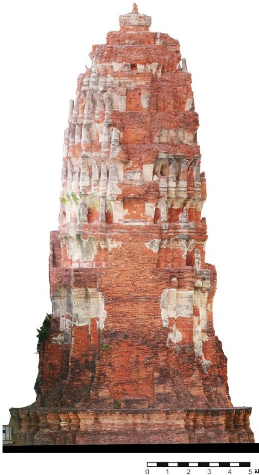
ภาพที่ 23 รูปด้านทิศตะวันตก เจดีย์ประธาน วัดลิงกา จากการรังวัดด้วยภาพ (Photogrammetry)
