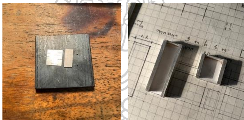
ภาพที่ 80 การขึ้นชิ้นงานตัวเรือน : กำหนดแบบแพทเทิร์นเพื่อนำไปฉลุนบนแผ่นเงิน เป็นส่วนประกอบต่าง ๆ ในการขึ้นตัวเรือน
