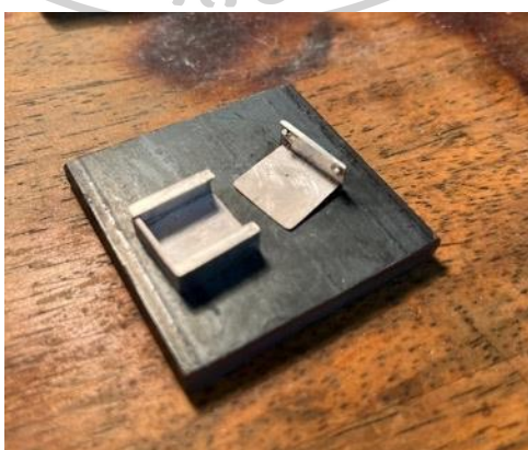
ภาพที่ 81 ทำชิ้นส่วนถอดสไลด์ในส่วนประกอบของชิ้นงาน โดยนำชิ้นส่วนมาเชื่อมประกอบกัน และนำชิ้นงานถอดสไลด์มาทดลองใส่กับชิ้นงานตัวเรือน และขัดแต่งชิ้นงาน
