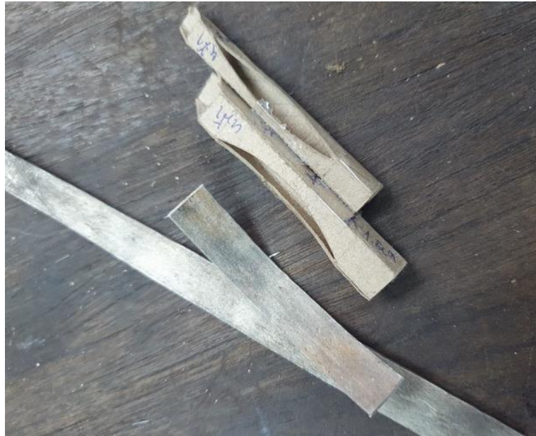
ภาพที่ 73 แผ่นโลหะและตัวต้นแบบกระดาษสำหรับขึ้นงานเข็มกลัด
