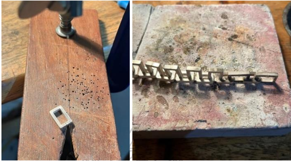
ภาพที่ 86 ทำการฉลุชิ้นงานที่ขีดแต่งแล้วให้ขาดเพื่อทำการร้อยโซ่ต่อกัน หลังจากนั้นนำมาเชื่อมรอยฉลุเพื่อความแข็งแรงของชิ้นงาน และขีดแต่งชิ้นงานอีกครั้ง
