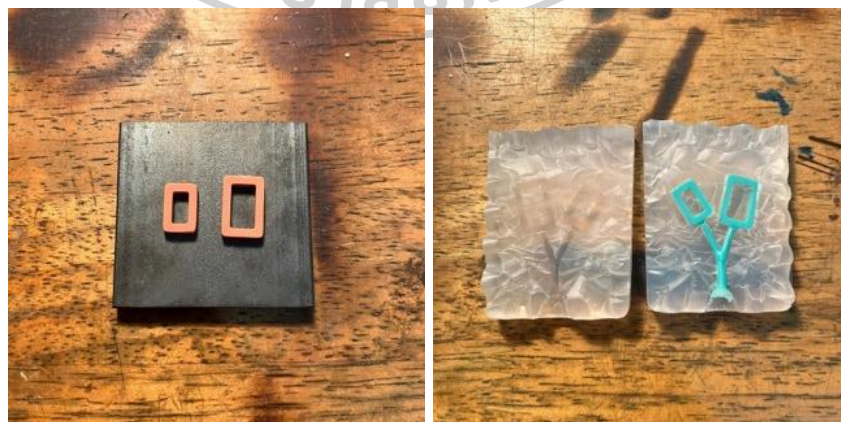
ภาพที่ 85 บริษัทชิ้นงานที่ได้ขึ้นต้นแบบจาก 3D เพื่อนำไปทำแม่พิมพ์ต้นแบบไปสู่กระบวนการหล่อขึ้นชิ้นต่อไป
