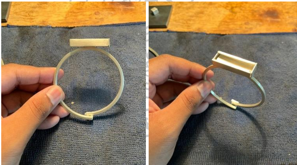
ภาพที่ 71 นำกำไลที่เคาะขึ้นรูปเสร็จเรียบร้อยแล้ว ไปเชื่อมกับตัวเรือนตามแบบที่กำหนดไว้และขัดแต่งชิ้นงาน
