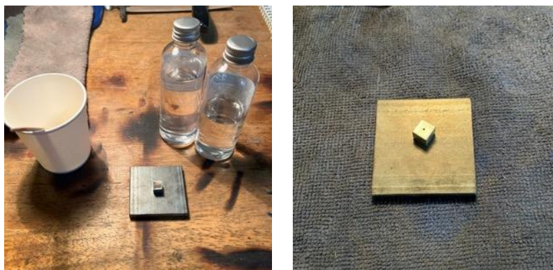
ภาพที่ 79 ทำความสะอาดชิ้นงาน นำชิ้นงานมาเทรซขึ้นด้านในเพื่อทำตัวยึดเข็ม พอเรซขึ้นเซตตัวได้ที่ นำชิ้นงานไปเลเซอร์แผ่นด้านบนเป็นการปิด ทำการเจาะรูด้านบนเพื่อสามารถเสียบเข็มลงไปได้ และขัดแต่งชิ้นงานให้เรียบร้อย
