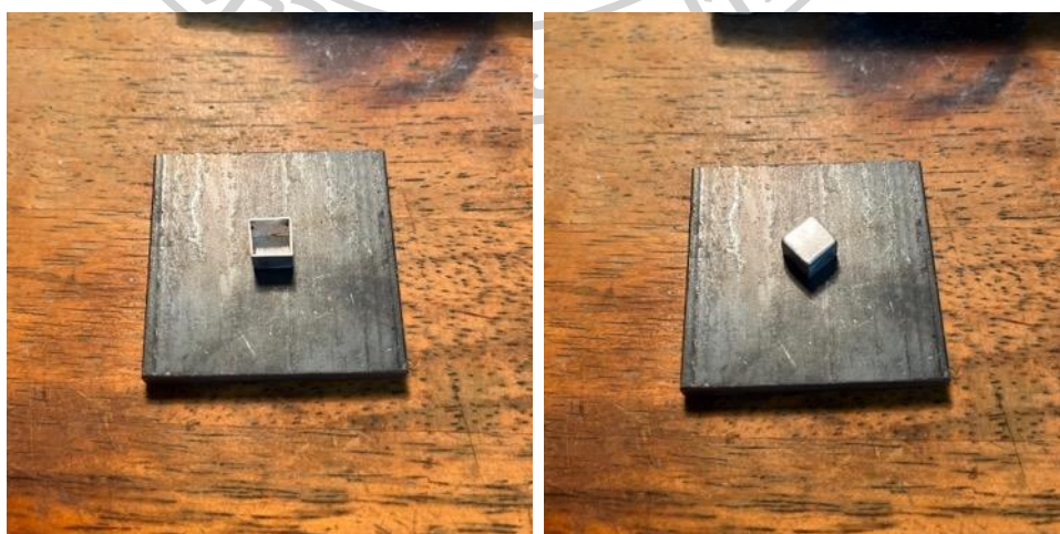
ภาพที่ 78 แผ่นเงินที่นำมาพับเป็นกล่อง นำมาเชื่อมเพื่อความแข็งแรง และชัดแต่งชิ้นงานให้เป็นกล่องสี่เหลี่ยม
