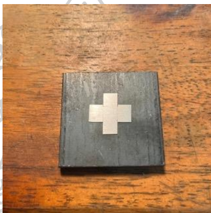
ภาพที่ 77 ชิ้นขึ้นงานสำหรับยึดปลายเข็มกลัด : นำแผ่นเงินมาฉลุตามแบบที่กำหนดไว้ บากรอยตามตำแหน่งที่กำหนดเพื่อทำให้พับแผ่นเงินง่ายขึ้น
