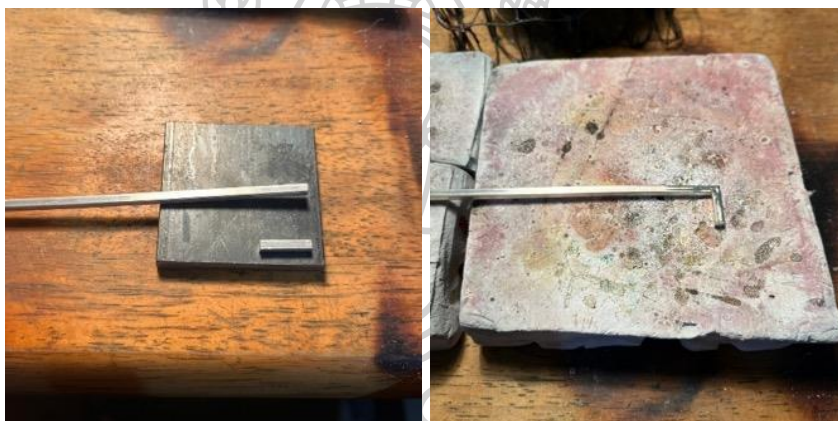
ภาพที่ 68 นำลวดเงินมาฉลุแบ่งทำส่วนประกอบ นำส่วนประกอบของลวดเงินมาเชื่อมประกอบกัน ในด้านหนึ่งของปลายลวด
