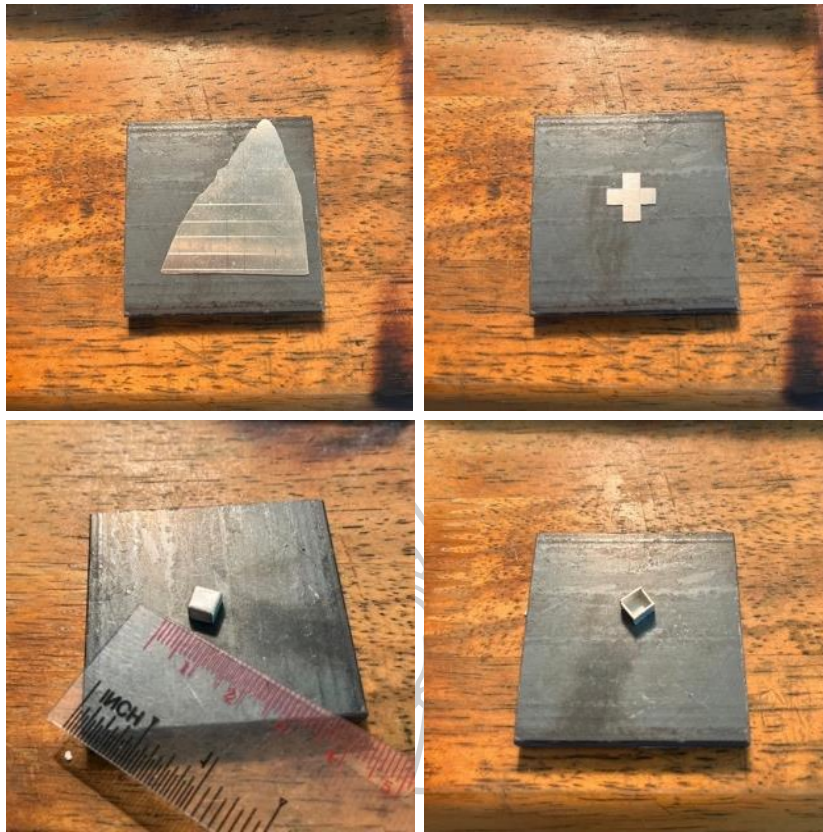
ภาพที่ 82 กำหนดแบบแพทเทิร์นเพื่อนำไปฉลุนแผ่นเงิน เป็นส่วนประกอบของชิ้นงานเข็มกลัด
