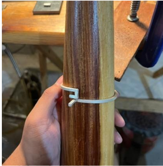
ภาพที่ 70 นำลวดที่เชื่อมส่วนประกอบเสร็จแล้วขัดแต่ง อบอ่อนด้วยความร้อนเพื่อนำไปเคาะขึ้นรูปบนกระบองกำไล
