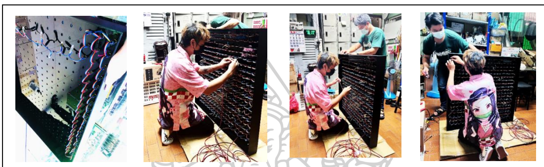
ภาพที่ 49 การติดตั้งหลอด LED Pixel IC8206 หัวกระสุน 12 mm. 0.36 w
