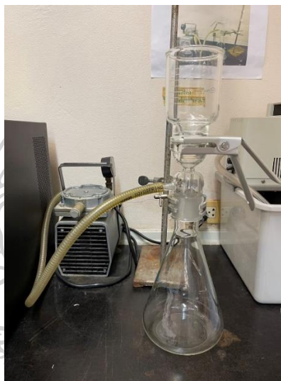
ภาพที่ 13 การกรองตัวทำละลายผสมด้วยเครื่องกรองระบบสุญญากาศ (Glass vacuum filter holder)
