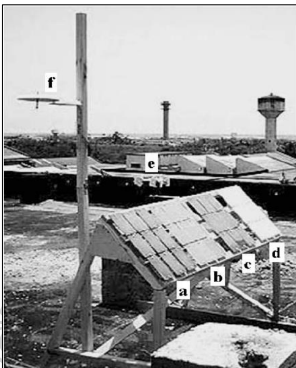
ภาพที่ 2 ชั้นวางเพื่อรองรับตัวอย่างวัสดุและอุปกรณ์ตัวอย่างแบบพาสซีฟ ที่มา: Tidblad et al. (2007)
